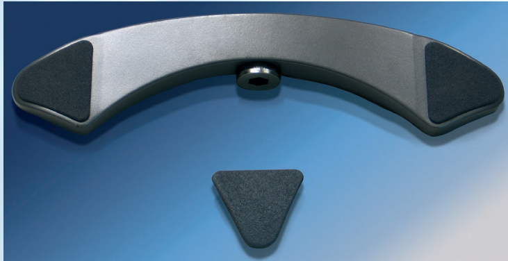
Fußbremse für Krankenhaus- und Pflegebetten: Der Bremsbelag wird mit einer reibungserhöhenden Schicht versehen. Der große Vorteil ist eine langfristige Funktionssicherheit bei geringer Abnutzung.
